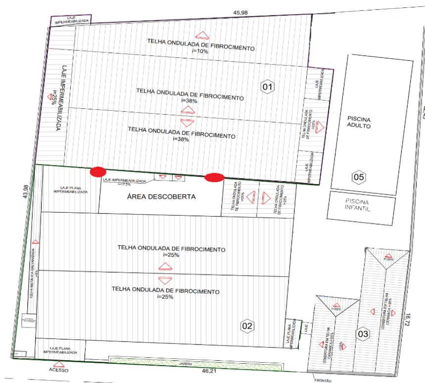
Foto 05: Representação dos locais sugeridos para instalação das escadas marinheiro
